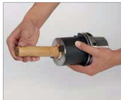
3. Очистить внутреннюю поверхность конуса и опорную поверхность
