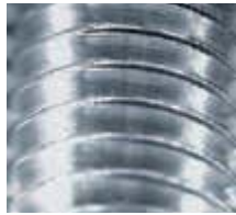
Гладкая поверхность при достаточной подаче СОЖ
