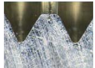
Профиль резьбы с использованием специального раскатника
