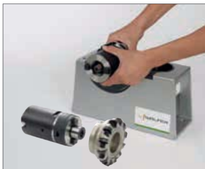
8. Вставить базовый держатель в соответствующий фланец.
