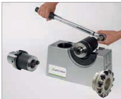
7. Затянуть динамометрическим ключом.
