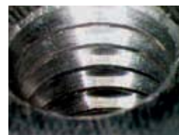
Метчик с покрытием DLC в АК7ч
